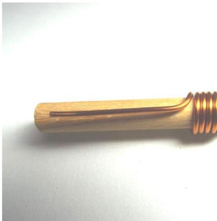
写真2（コイルの端で折り曲げる）
