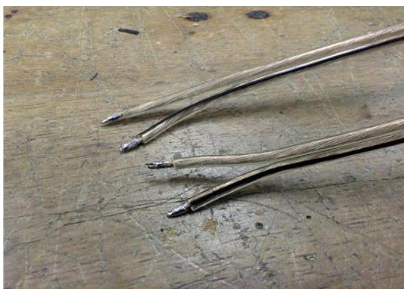
図9 はんだ付け済みスピーカーケーブル
