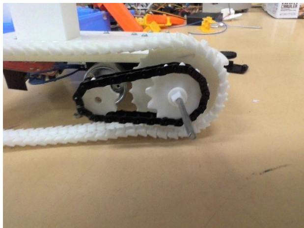
図 9 サブクローラの駆動部分
