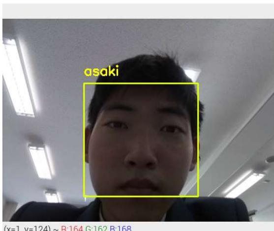
図 5 OpenCV を使った顔認識
