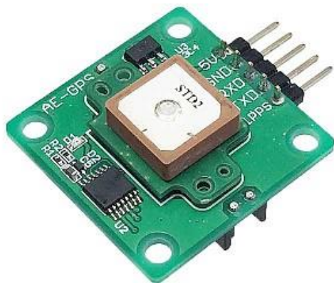
写真3 GPS モジュール
