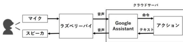
図1 AIスピーカの仕組み
