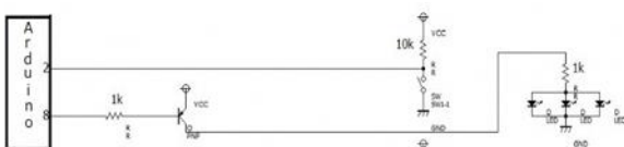
図3 スイッチ&ランプの制御回路
