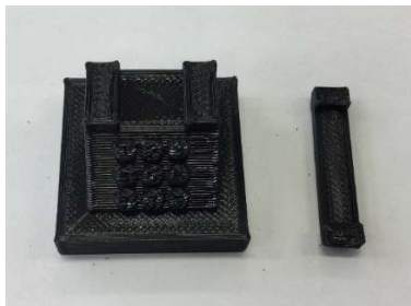
図9 3D CADで設計し出力した電話機 (2)マイコンについて
