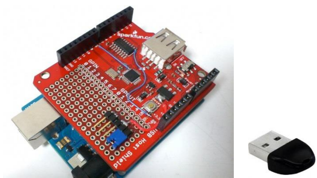
図7 USB ホストシールドと Bluetooth アダプタ
