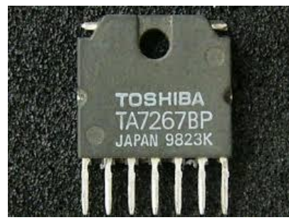
図5 東芝バイポーラ形リニア集積回路
