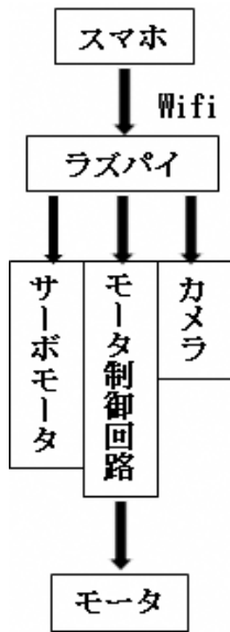
図3 レスキューロボットのブロック図 今回は Wi-Fi を使用してスマートフォンから遠隔操作できるようにする。使用する主な部品は、上の図3のように接続する。
