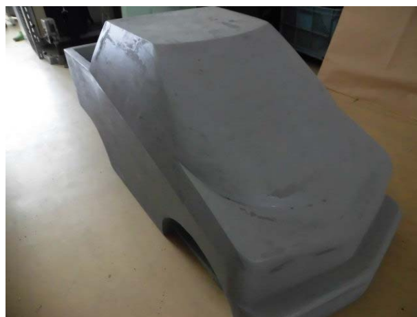
図6 発泡スチロールのFRP型
