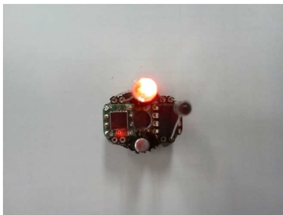
写真10 LED の取り付け
