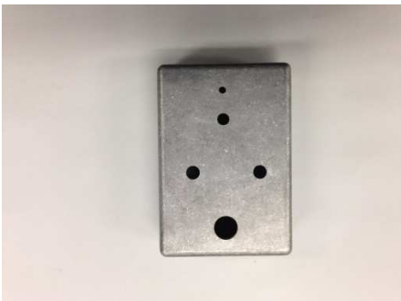
図7 ディレイの箱の加工
