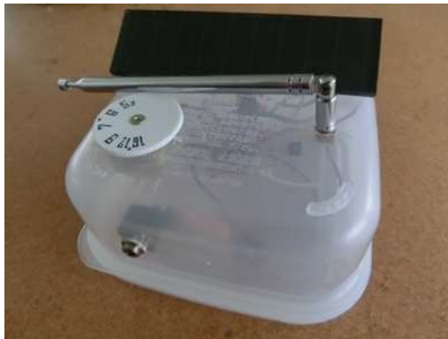
写真5 製作した一石トランジスタラジオ
