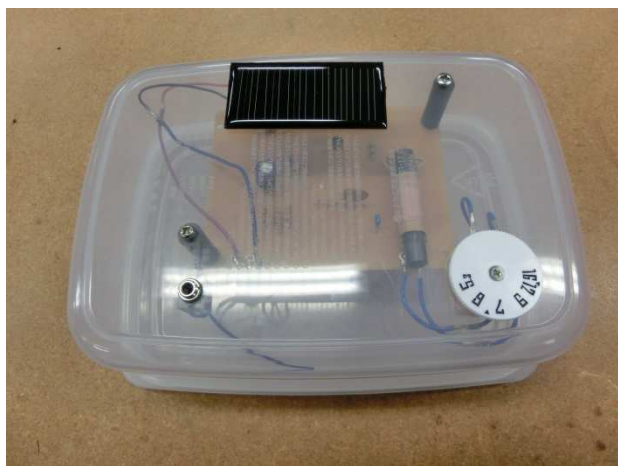
写真 7 製作した一石レフレックスラジオ
