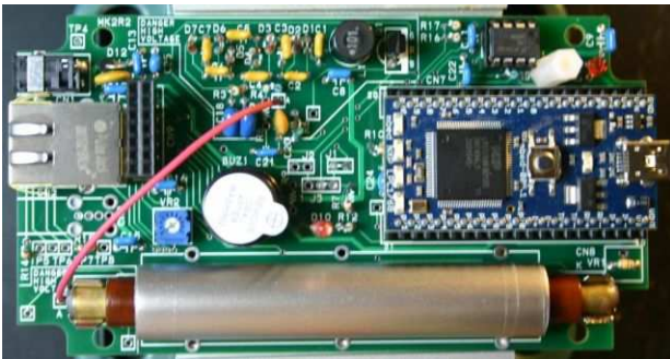
図3 放射線測定器の基盤
