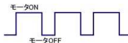
図 4.2.1 (PWM 制御の信号)
