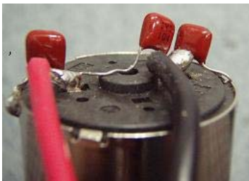
図 15 コンデンサの取り付け
