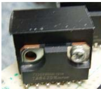
図 8 ヒートシンクの取り付け
