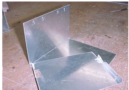
図4 前後ろボディアルミ板曲げ加工
