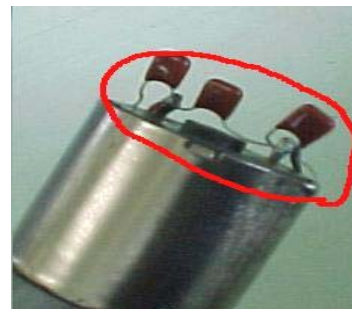
図4 コンデンサーを取り付けたところ
