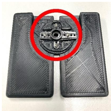
図8 足にサーボボーンを取り付ける
