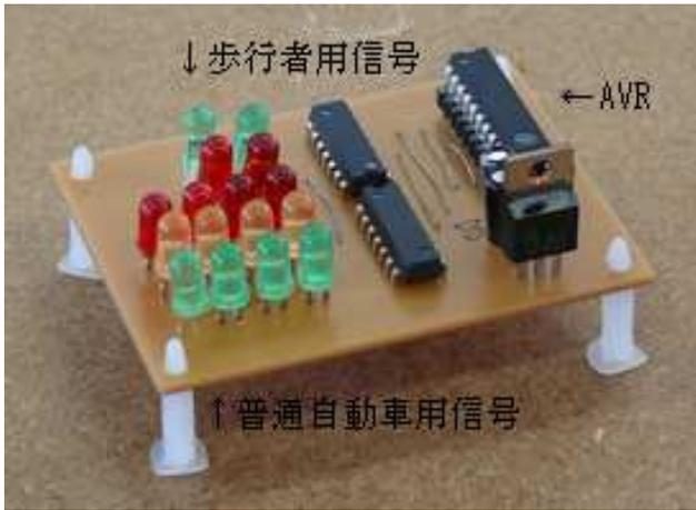
図 1 交通信号機実験回路
