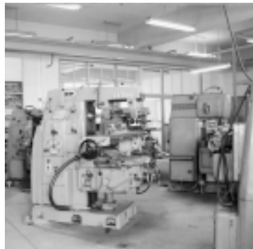
近代的に整備された実習室。特殊機械実習で使用する横フライス盤と立てフライス盤。
